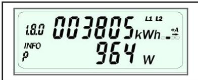
Spannungsausfall einer Phase
