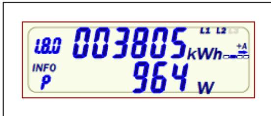
Spannungsausfall einer Phase
