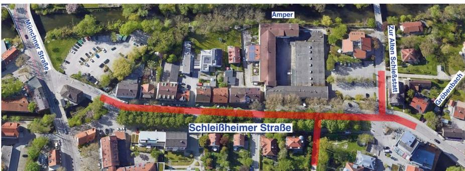
Die im vergangenen Jahr in der inneren Schleißheimer Straße neu gebaute Trinkwasserleitung ist zwischenzeitlich an das Netz angeschlossen. Jetzt im Frühjahr gehen hier die Bauarbeiten weiter: Zwischen der Brücke über den Holzgartenkanal und der Brücke über den Gröbenbach werden der 90 Jahre alte Regenwasserkanal der Stadt sowie der Schmutzwasserkanal der Stadtwerke neu gebaut. Ebenso werden die Anschlussleitungen zu den vorhandenen
